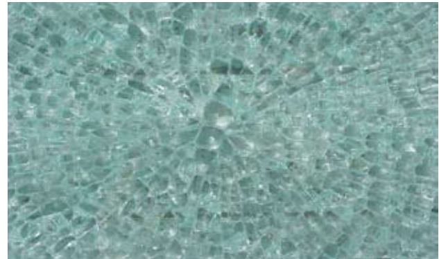
Abbildung 3: NiS-Einschluss mit „Schmetterling“.
