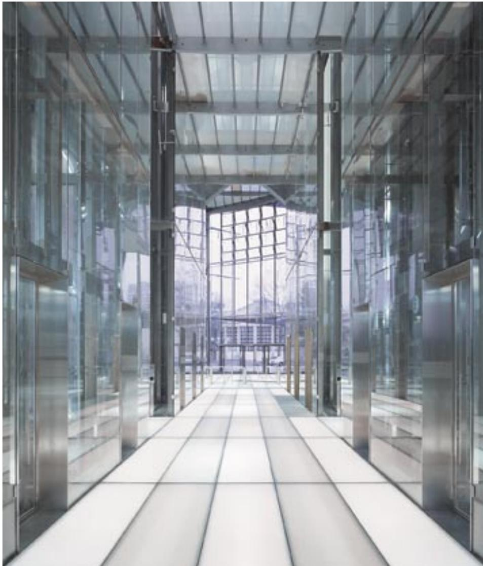
Erschließungszone im Zentrum des Foyers: Von hier aus wird das Gebäude über zwei Gruppen von je sechs transparent eingehausten Aufzügen in der Höhe erschlossen. Böden und Decken sind aus begehbarem, siebbedrucktem Weißglas.
