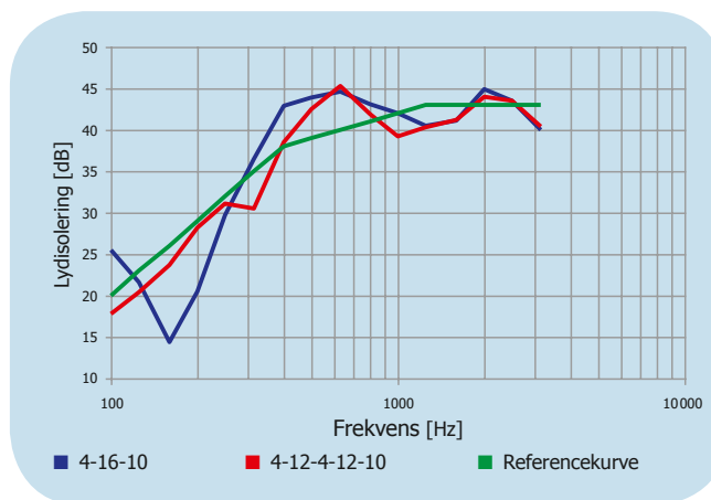
Figur 5: Sammenligning af to termoruder, hvor R_w = 39 dB
