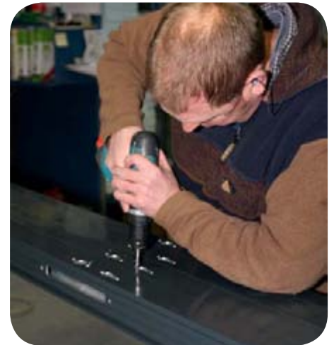
Schlösser und Beschläge werden im Werk in Schüttorf vormontiert, und selbst größere Elemente werden vor dem Transport an die Baustelle zunächst im Werk komplett montiert, um Präzision in der Fertigung und Vollständigkeit in der Ausstattung sicherzustellen.
