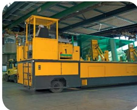
Innerbetriebliches Glastransportfahrzeug im Verbund-sicherheitsglasbetrieb.
