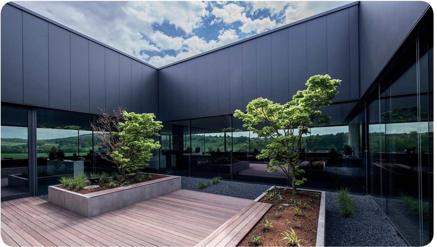
Festverglasungen ohne Vertikalrahmung, metallische Fassadenplatten in Carbonoptik, Sichtbeton und Naturholz sind die dominanten Baumaterialien. © STEINBAUER Performance.
