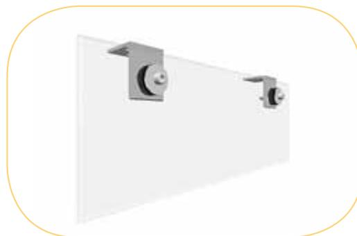
Associés à un système de désenfumage, les écrans de cantonnement constituent une composante essentielle afin de limiter la propagation des fumées et gaz chauds produits lors d'un incendie. Leur rôle est de s'opposer à l'écoulement latéral des fumées et des gaz chauds en formant une barrière verticale à l'intérieur des grands espaces.
