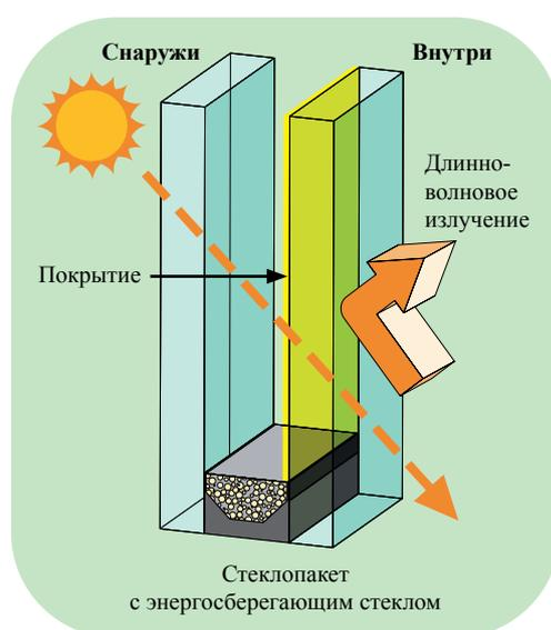
Обычно теплопотери измеряются величиной  $U_g$  – коэффициентом теплопередачи. Это поток тепловой энергии в ваттах, проходящий через один квадратный метр конструкции, при перепаде температуры воздуха снаружи и внутри помещения в 1 градус Кельвина ( $Вт/м^2К$ ). Чем ниже коэффициент теплопередачи, тем лучше теплоизоляция. В России коэффициент теплопотерь также обозначается как  $R_0$ .
