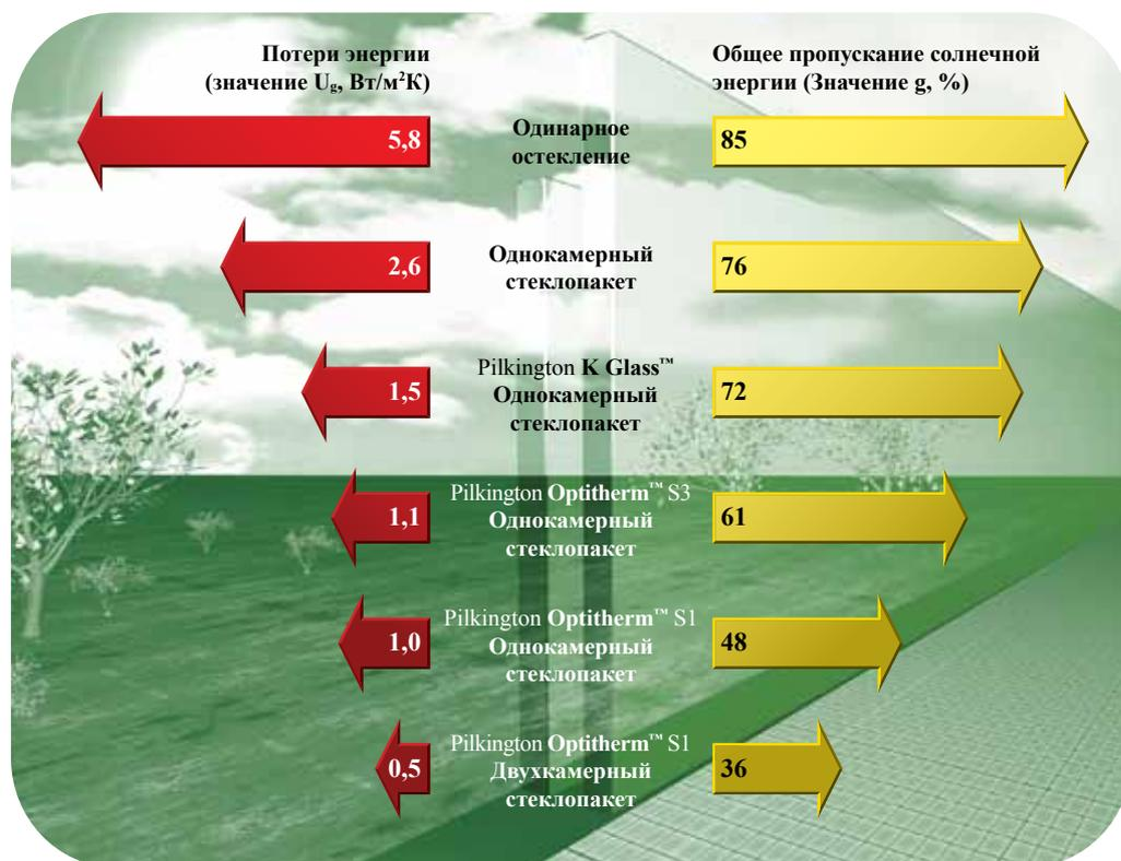
\* Экономия энергии (общая теплопередача) и теплотери от однокамерного стеклопакета до стеклопакетов высшего класса. Теплоизоляционные характеристики определены в соответствии с EN 673. Оптические характеристики определены в соответствии с EN 410. Значения для однокамерных стеклопакетов даны для стандартных конфигураций 4-16-4 с аргоном (90%). Значения для двухкамерных стеклопакетов даны для стандартных конфигураций 4-16-4-16-4 с аргоном (90%).
