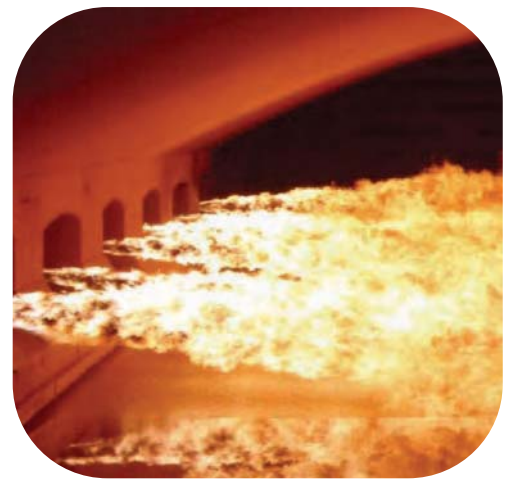
2. 熔窑内部 加热至 1600^{\circ}\text{C}
