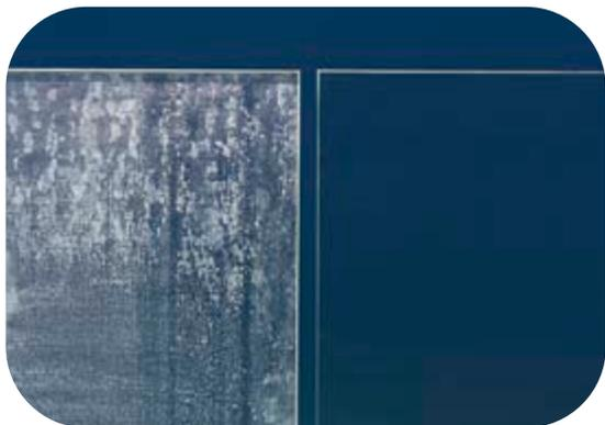
Des essais de vieillissement à haute température et humidité montrent que Pilkington **OptiShower™** limite le processus corrosif et les dépôts calcaires par rapport au verre non traité.
