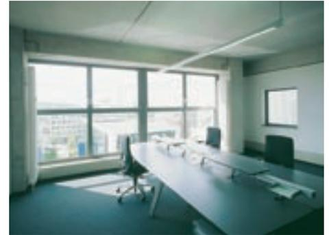
**Büroraum in einem der Regelgeschosse des Silos: Die hohe Lichtdurchlässigkeit von Pilkington Suncool Brilliant 66/33 sorgt für reichlich Tageslichteinfall, zugleich konnte aufgrund der hervorragenden Selektivität der Sonnenschutzgläser auf eine aufwändige Klimatisierung verzichtet werden.**
