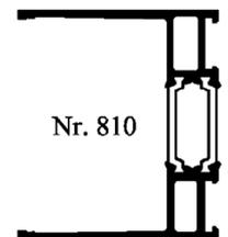
Vertikalverglasungen aus nicht heißgelagertem, thermisch vorgespanntem Profilbauglas
