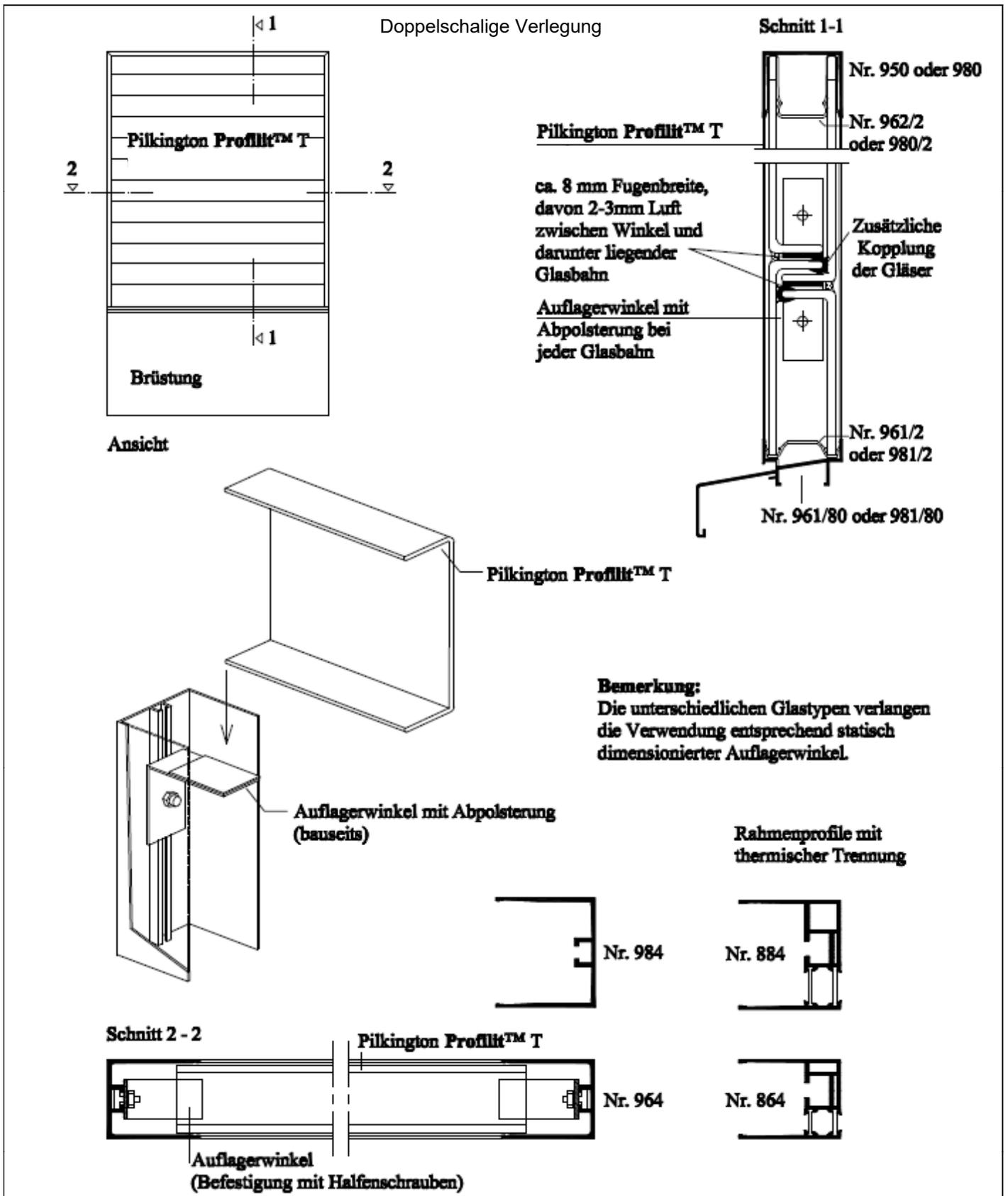
Vertikalverglasungen aus nicht heißgelagertem, thermisch vorgespanntem Profilbauglas "Pilkington Profilit T" und "Reglit T"
