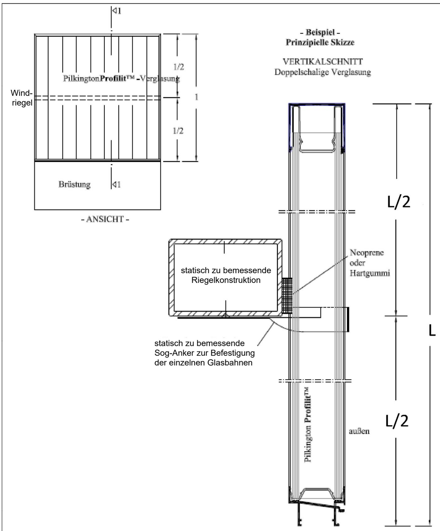
Vertikalverglasungen aus nicht heißgelagertem, thermisch vorgespanntem Profilbauglas "Pilkington Profilit T" und "Reglit T"
