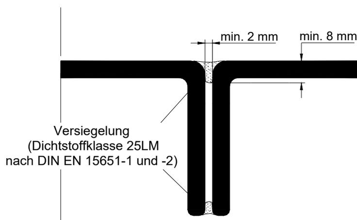
Vertikalverglasungen aus nicht heißgelagertem, thermisch vorgespanntem Profilbauglas
