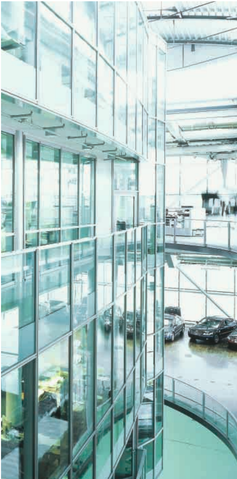
Der offene Eventbereich: Eine brandlastfreie Zone, schwer entflammare Möblierung (A1), Detektion, Vollsprinklerung und Entrauchung gehören zu den vernetzten Brandschutzmaßnahmen. Foto: Volkswagen AG
