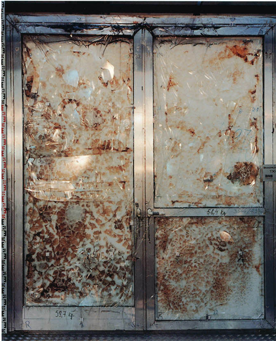
◀ Die feuerabgewandte Seite der übergroßen GLISSA 2000 / PYROSTOP Türkonstruktion nach einer Brandprüfung im September '96 (H: 2,8 m ; B: 2,5 m). Die Prüfkriterien Feuer-/Rauchdichte und Thermische Isolation wurden in allen Punkten erfüllt.
