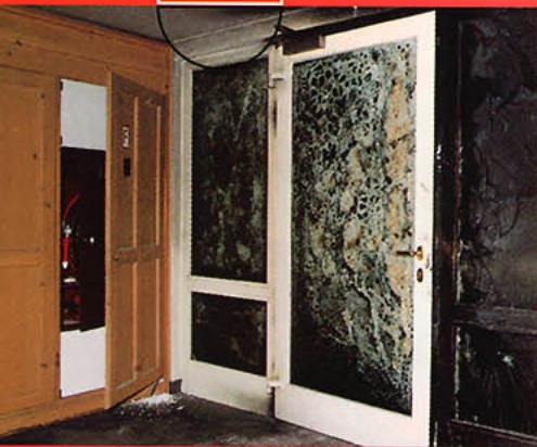
Hotelbrand am Spitzingsee: Die Analyse realer Brände bestätigt die Leistungsfähigkeit von PYRODUR und PYROSTOP Verglasungen.
