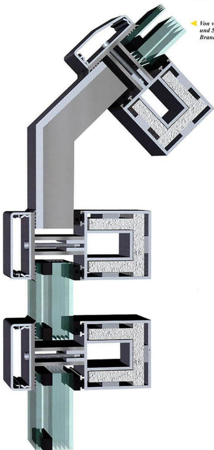
◀ Von vertikal zu geneigt: Schnitt durch Fassade und Schrägdach mit elegantem Übergang durch Brandschutz-Führungselement.
