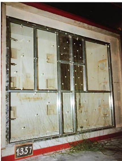
Probekörper vor einem Brandversuch im MPA
