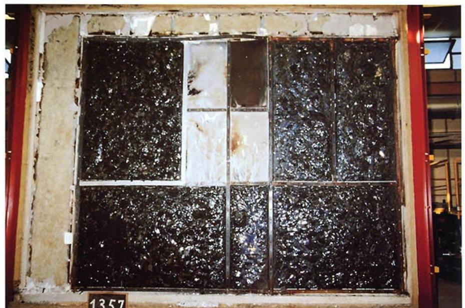
Die dem Brandraum zugekehrte Seite eines Probekörpers nach Abschluss eines Brandversuchs:
