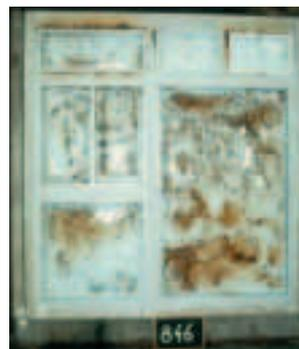
Das FlamTec-System mit Pilkington **Pyrostop** vor, während und nach dem Brandversuch: Alle Anforderungen an Feuer- und Rauchdichte sowie thermische Isolation wurden erfüllt.
