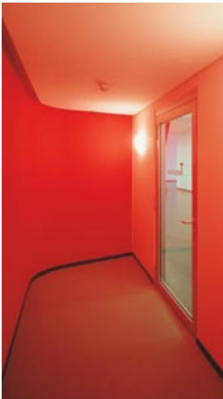
Signalfarbe Rot: Die innenliegenden, gut gekennzeichneten Fluchttreppenträume münden über das 1. Untergeschoss ins Freie. Alle F 30/T 30-Türsysteme sind mit Pilkington Pyrostop verglast.
