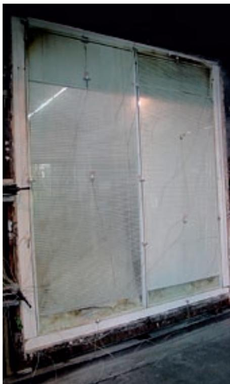
Vorversuch mit der neuen Systemwand Synops Photo, deren Hauptmerkmale die integrierten Jalousien und die innovative Klebtechnik zur Befestigung der Verglasung an der Rahmenkonstruktion sind.
