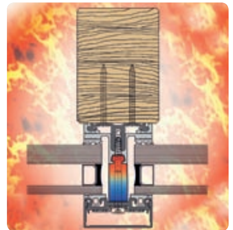
Brandschutz für die Fassade, kombiniert mit optimaler Wärmedämmung: FERRO-WIC-Systeme erreichen durch die Integration eines „Elastomerschaumkaders“ U_f -Werte < 1,5 \text{ W/m}^2\text{K} .
