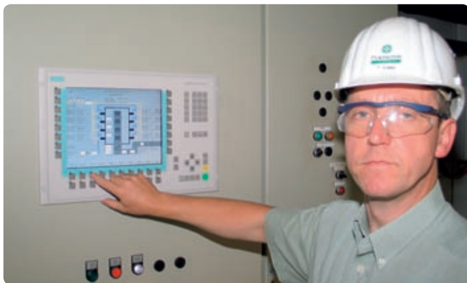
Kontrollwarte der neuen Brandprüfungsanlage von Pilkington: Anlagen- und Prüfdaten des Glases bzw. der Konstruktion werden über den gesamten Prüfzeitraum hinweg elektronisch erfasst und können in Verbindung mit Videoaufnahmen der Prüfung detailliert ausgewertet werden.
