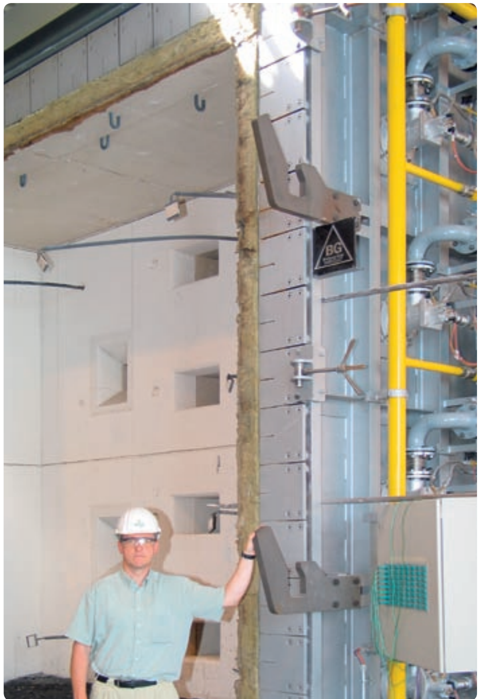
Günter Höller vor der neuen Brandprüfungsanlage: Rahmen mit einem Öffnungsmaß von bis zu 4 m x 4 m können mit verschiedenen Formteilen bestückt werden.
