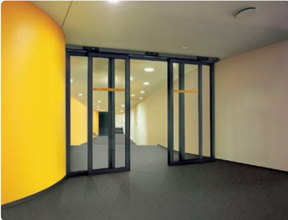
Weltneuheit: Die T 30-Schiebetür der Firma Hörmann KG. Das elegante System in Aluminium-Bauweise kommt im Übergangsbereich ohne Führungsschienen aus.
