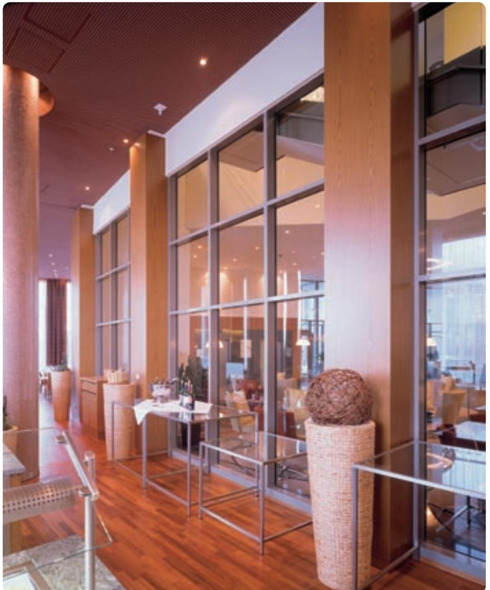
Die F 30-Trennwand ermöglicht die ästhetische Trennung der Brandabschnitte.
