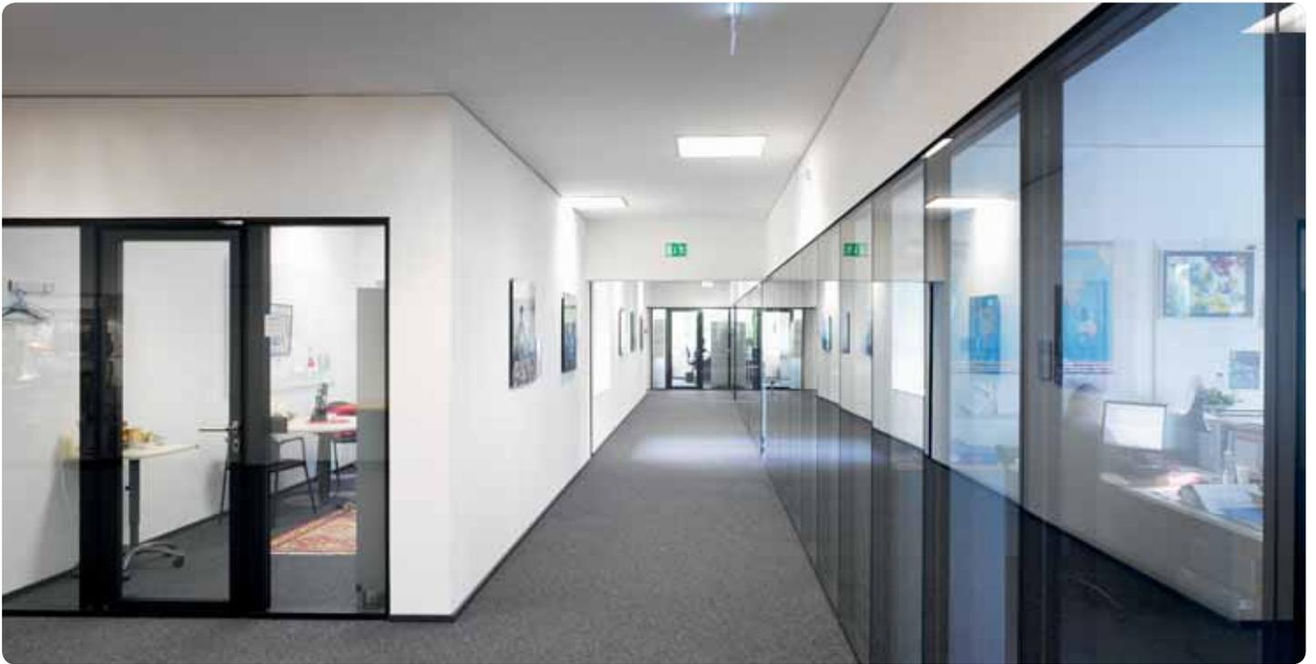
elementen in Kombination mit Pilkington **Pyrostop®** in Structural Glazing-Optik und innovativer dreischaliger Bauweise. Im Bereich der als Fluchtwege genutzten Büroflure sowie bei den Zugängen zu Schleusen und den angrenzenden Treppenträumen kommen diese Systemkonstruktionen zum Einsatz, bei denen die F 30-Verglasung mit Pilkington **Pyrostop®** im Zwischenraum einer 100 mm starken Glaswandkonstruktion positioniert ist, dessen beide
