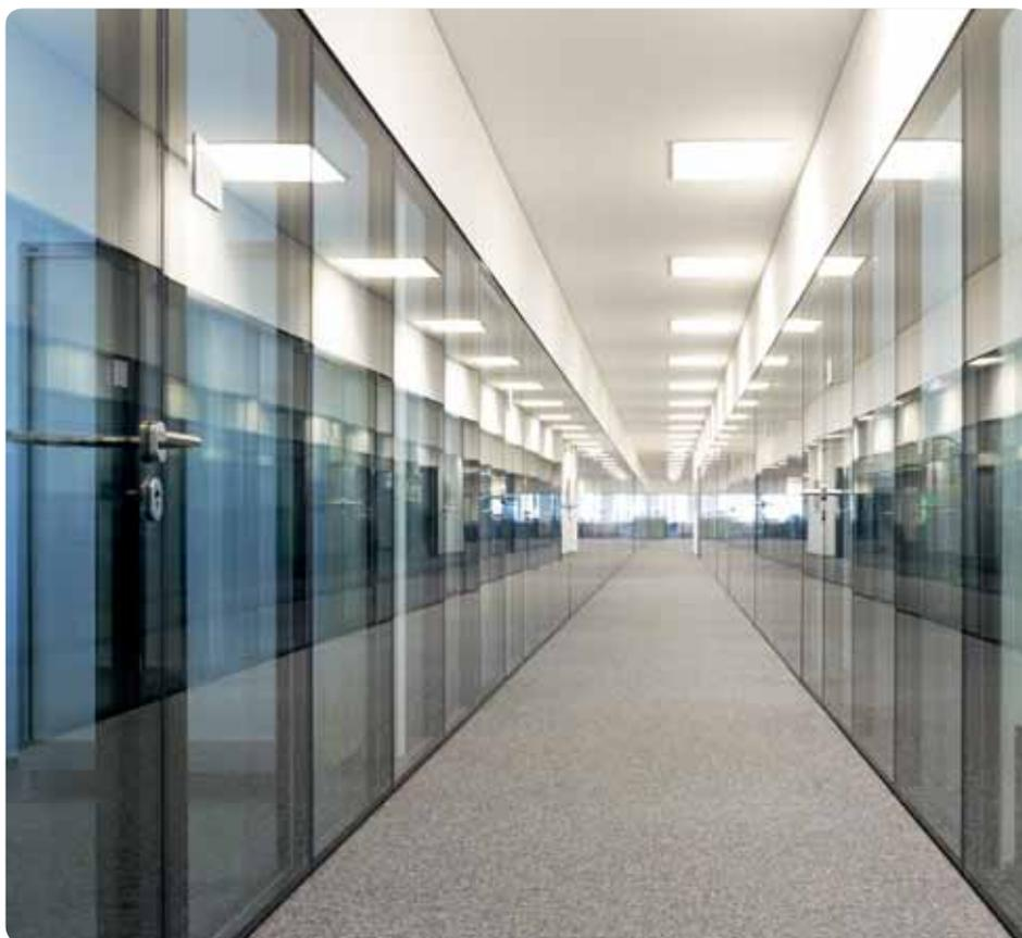
Fluchtweg in einer Flucht: Trennwand-Elemente und Türen von nur 10 cm Elementdicke erfüllen durch die mittige Integration eines Pilkington **Pyrostop**®-Glaselementes hohe Brandschutz- und optimierte Schallschutzanforderungen.
