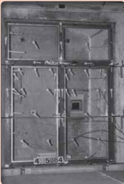
1984: Versuchsaufbau eines Norm-Brandversuchs am ersten Prüfofen der Flachglas AG. Bild vor dem Start des Brandversuchs.
