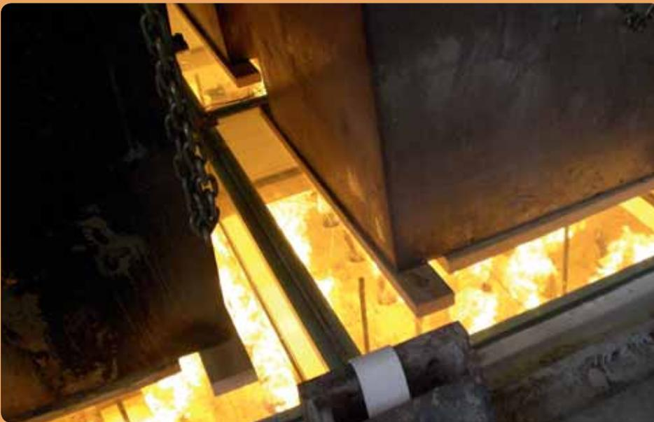
Begehbare EI 120-Verglasung mit Pilkington **Pyrostop**® beim „Floor Test“ in den USA: Jedes einzelne Segment wurde mit wasserbefüllten Stahlcontainern (je 1.100 kg) belastet und von unten befeuert – die Verglasung hielt diesen Belastungen 125 Minuten stand, womit der Test als sicher bestanden galt.
