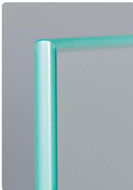
Durch ein eigens entwickeltes, brandschutzspezifisches Kantenbearbeitungsverfahren erfüllt Pilkington **Pyroclear®** mit systemkompatiblem Glaseinstand von 13 mm, +2 mm/-3 mm, zuverlässig die ihm zugeordnete Funktion im Brandfall (hier ohne Kantenschutzband dargestellt).
