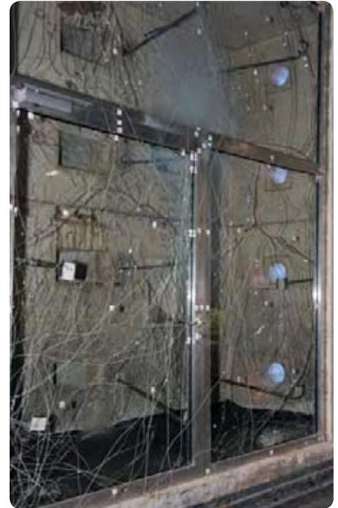
Brandversuch an einem zweiflügeligen T 30/F30-System von alufam mit einem ungeteilten, quer liegenden Oberlicht von 3.000 x 1.400 mm Größe. Die Flügelbreite beträgt 1.640 x 2.308 mm.
