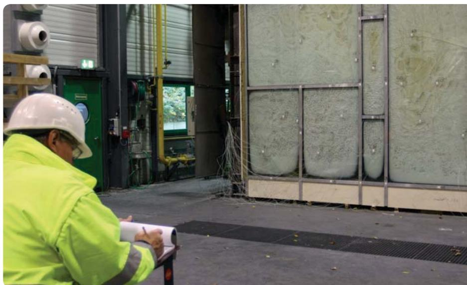
Alle Phasen eines Brandversuches werden registriert – Temperatur-Messfühler über die gesamte Fläche verteilt registrieren lokale Temperaturentwicklungen.
