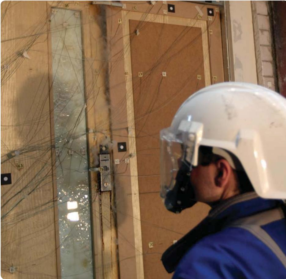
oder in der Fassade. Das Interessante an Brandschutzgläsern ist das große Produktspektrum zwischen G (E) 30 und F (EI) 120 und die unterschiedlichen Glasaufbauten bzw. Konstruktionsprinzipien, die im Rahmen von Brandprüfungen jeweils ihre speziellen Leistungsprofile und Merkmale entwickeln.
