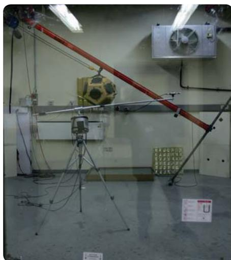
Ein neuer Glastype für die F 30-Klasse als Dreifach-Isolierglas erzielt einen  $R_w$ -Wert von 46 dB und bietet dem Systemhersteller eine gute Möglichkeit, die Schallschutzklasse 4 zu erreichen.
