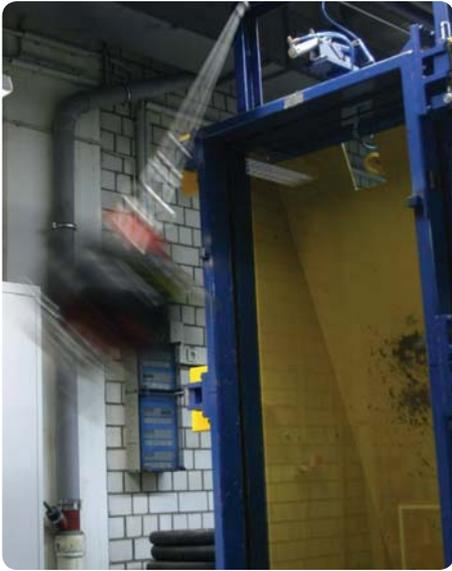
Pendelschlagversuche geben Aufschluss über das sicherheitstechnische Verhalten der Scheiben. Pilkington **Pyrostop®** und Pilkington **Pyrodur®** erzielen aufgrund ihres Mehrschichtaufbaus diesbezüglich sehr gute Werte.
