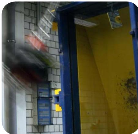
Pendenschlagversuche unter normierten Prüfbedingungen (EN 12600) geben Aufschluss über die Sicherheitseigenschaften einzelner Brandschutzglastypen.
