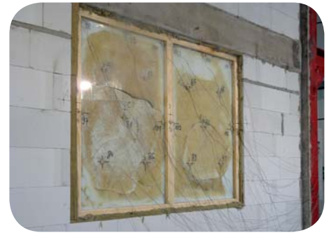
Zum Ende immer noch sehr sicher: 48 Min. Raumabschluss
