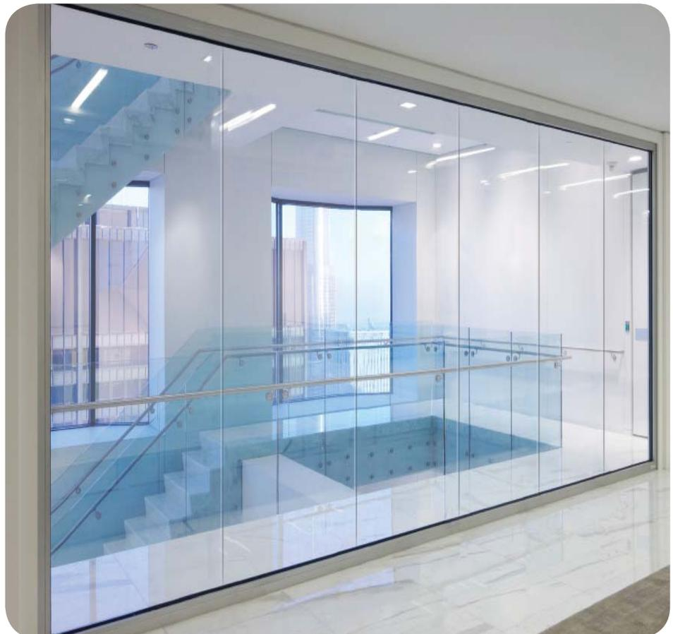
Flächenbündige Trennwand ohne Vertikalrahmung mit Pilkington Pyrostop® Line im Objektbeispiel: Ab sofort ergänzen zwei neue einschalige Glastypen für die Feuerwiderstandsklassen bis EI(F) 60 das Angebot. Foto: TGP
