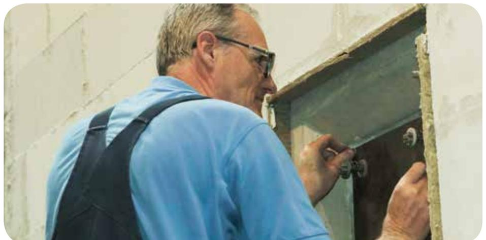
Montage eines der insgesamt fünf Messfelder, an denen über den Prüfzeitraum von 66 Minuten fortlaufend Druck- und Temperaturwerte abgenommen werden.
