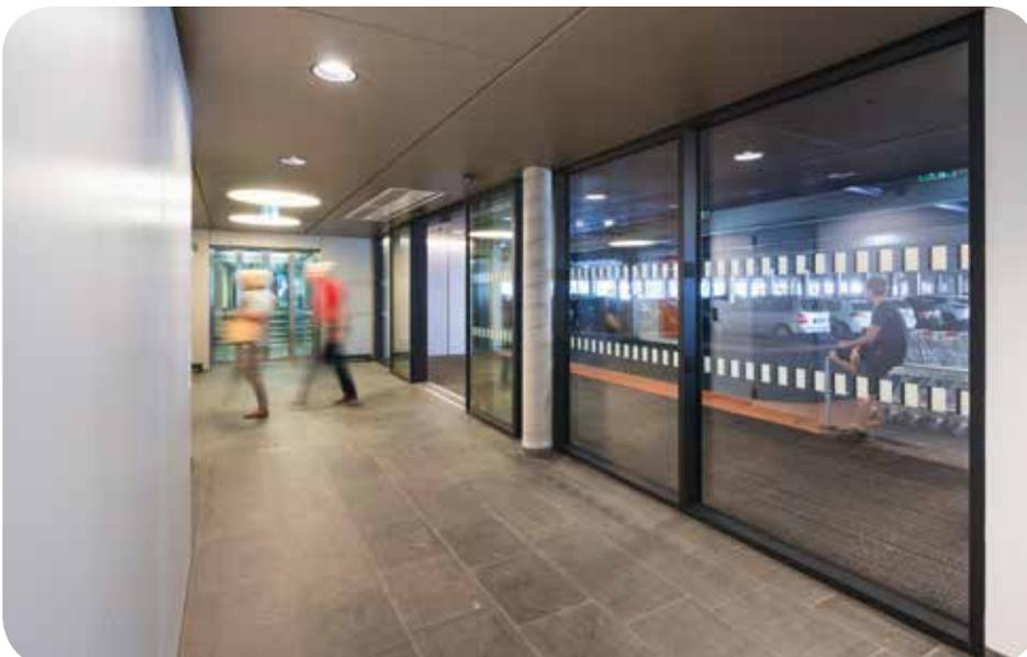
Die durchgängig eingesetzten Pilkington **Pyrostop®** Brandschutz-Isolierverglasungen wurden mit einem Raster für den Auflaufschutz versehen.
