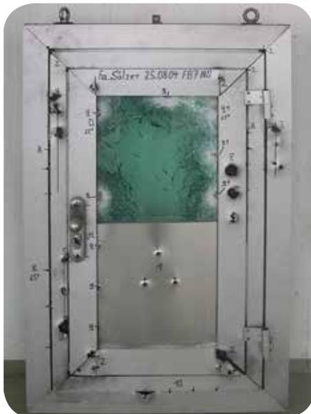
Individuelle Sicherheitskonfiguration: Die Aluminiumtür der SÄLZER Serie S2es – hier nach einem Besusstest gemäß DIN EN 1522/1523 – kann je nach Anforderungsprofil zusätzlich mit Einbruchhemmung und Explosionsschutz ausgestattet werden.
