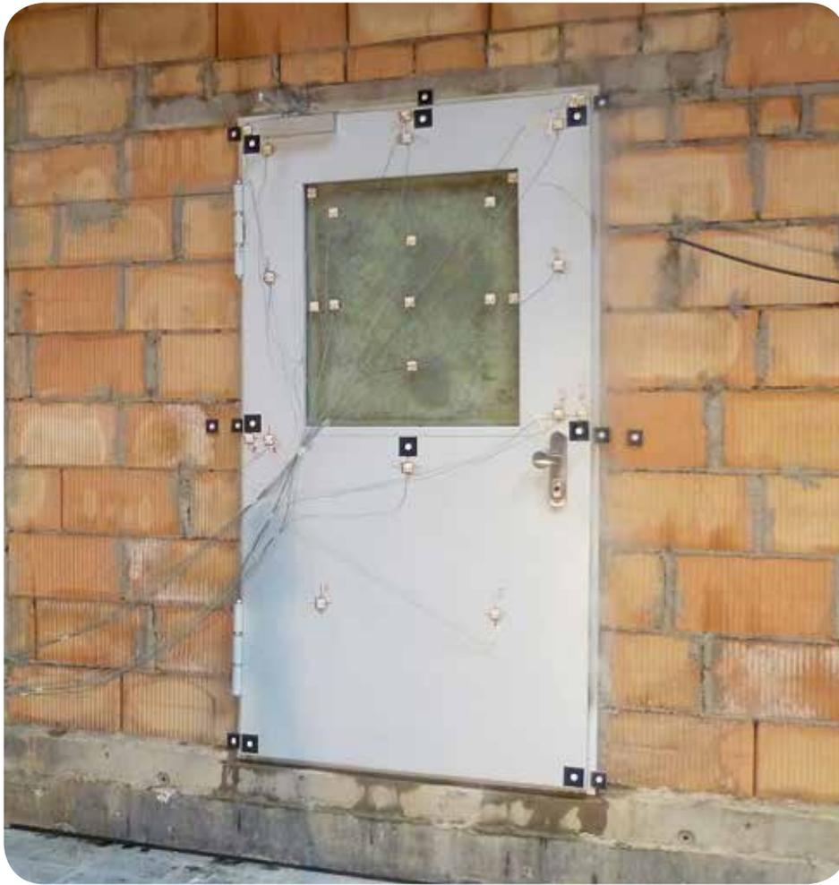
Komprimiertes Sicherheits-Know-how in einem Produkt: Hochsicherheitstür aus der SÄLZER Serie S4 im Norm-Brandversuch. Die Tür kombiniert Schutz vor Einbruch, Durchschuss und Explosion mit Pilkington **Pyrostop®** der Feuerwiderstandsklasse EI 90.
