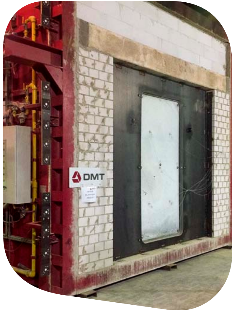
Prüfung eines Schiffsschotts mit Pilkington Pyrodur ® TM: Neben dem Brandschutz bestehen erhöhte Anforderungen an die Systemverglasungen.
