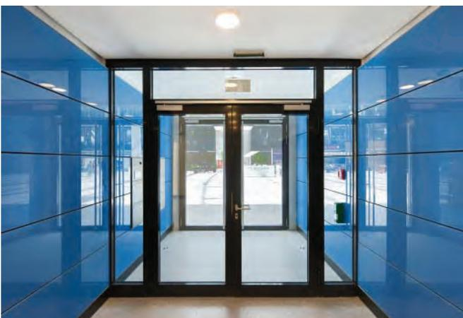
Zweiflügelige T 30 RS-Türsysteme führen in die Sicherheitsschleusen, die Zugang zum Aufzugsvorraum und zum Treppenraum ermöglichen. In 16 der 32 Sicherheitstreppe Räume wurden zusätzlich Zugänge zu den Feuerwehraufzügen über die Sicherheitsschleuse integriert.
