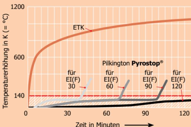
Temperaturerhöhung im Prüfofen gemäß Einheits-Temperaturzeit-Kurve (ETK). Die maximal zulässige mittlere Temperaturerhöhung auf der feuerabgekehrten Oberfläche beträgt 140 K (= °C). Die Oberflächentemperatur von Pilkington **Pyrostop**® bleibt innerhalb der geforderten Feuerwiderstandsdauer deutlich unter dem zulässigen Wert.
