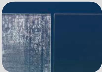
Test di invecchiamento ad elevate temperature e umidità dimostrano che Pilkington **OptiShower™** limita i processi corrosivi e il deposito di calcare rispetto ad un vetro non trattato.
