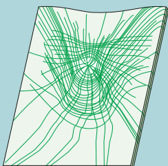
Bei der Beschädigung von Verbundsicherheitsglas zerspringt das Glas ähnlich wie gewöhnliches Floatglas, die Scherben bleiben jedoch an der innenliegenden Folie haften. So wird das Verletzungsrisiko minimiert.
