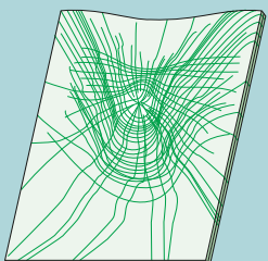
Bei der Beschädigung von Verbundsicherheitsglas zerspringt das Glas ähnlich wie gewöhnliches Floatglas, die Scherben bleiben jedoch an der innenliegenden Folie haften. So wird das Verletzungsrisiko minimiert.
