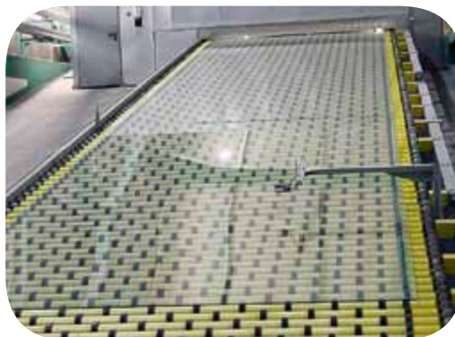
Im Werk Weiherhammer können bis zu 20 Meter lange Pilkington Optiwhite™ -Gläser produziert werden.
