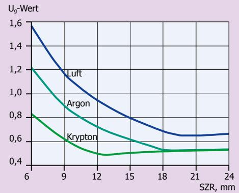
Das Diagramm zeigt den  $U_g$ -Wert bei verschiedenen SZR abhängig von der Gasfüllung. Die Graphen beschreiben ein Dreifachisolierglas mit zwei Pilkington **Optitherm™** S3 Scheiben und einer Pilkington **Optifloat™** Scheibe dazwischen.
