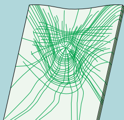
Bei der Beschädigung von Verbundsicherheitsglas zerbricht das Glas ähnlich wie gewöhnliches Floatglas, die Scherben bleiben jedoch an der innenliegenden Folie haften. So wird das Verletzungsrisiko minimiert.
